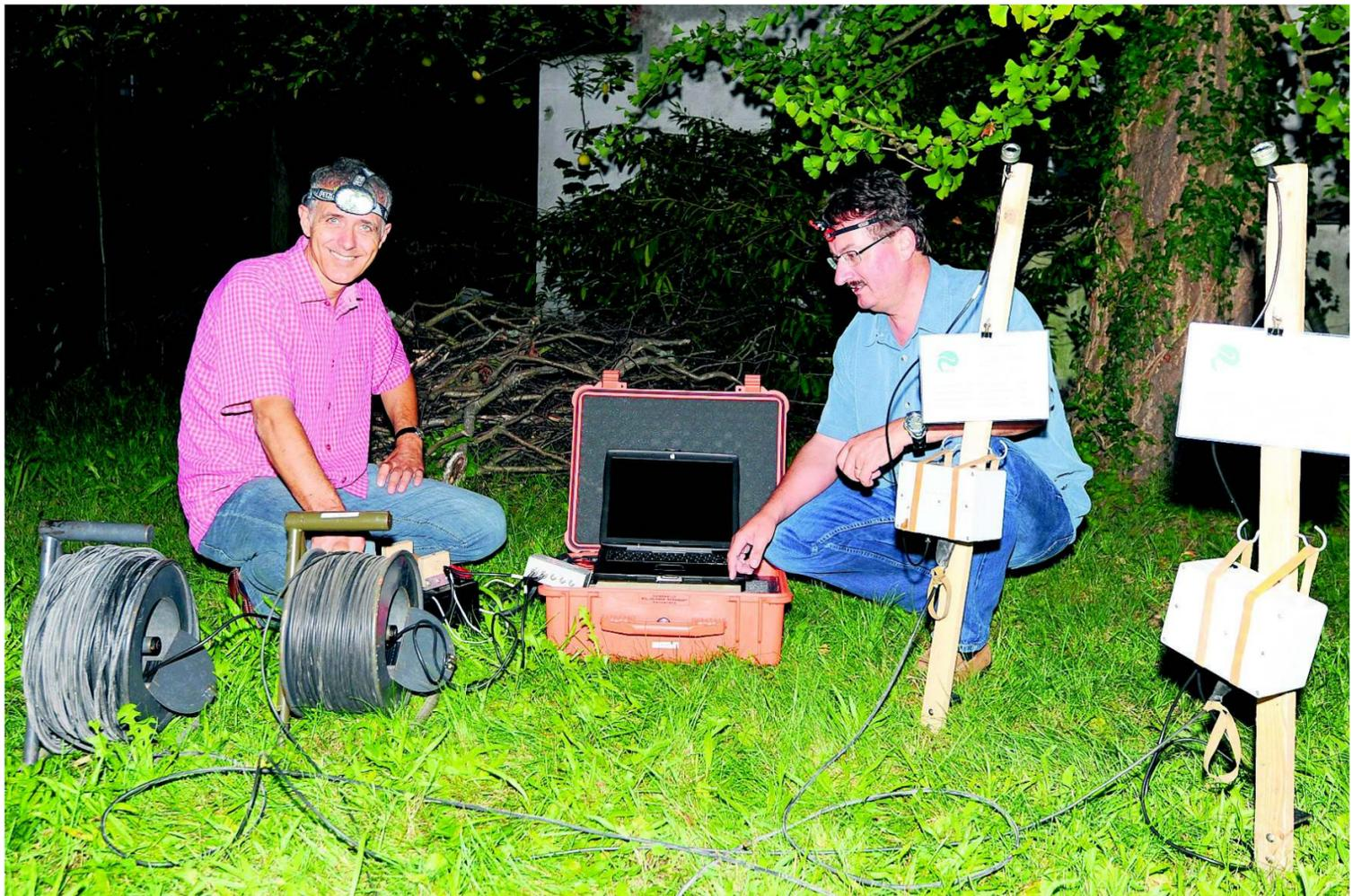
«Die Geräte sind Geschichte ...» Peter Flückiger (links) und Martin Obrist mit dem schwergewichtigen Equipment, das sie anfänglich für die Anwendung der neuen Methode benötigten: auf Holzplatten befestigte Mikrofone, Laptop, Bleibatterien und Kabelrollen.
