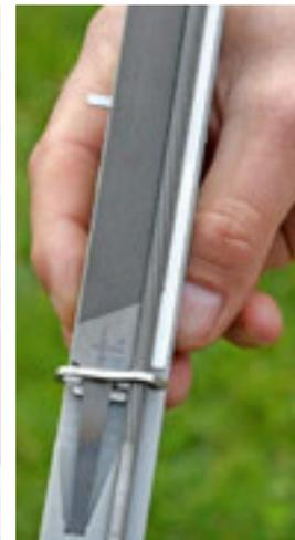
Mario Tabozzi erklärt die Schärfmaschine von Vallorbe. Sie arbeitet mit Flach- und Rundfeile, die in eine Führungsschiene eingespannt werden (linkes Bild). Stepan Isler
