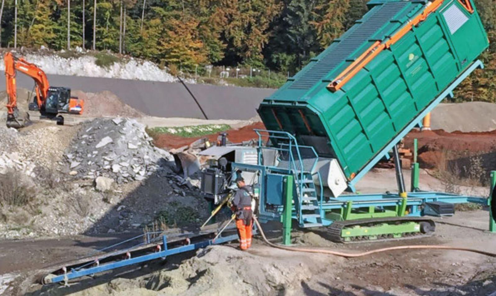
Das neue Mischgerät mit Förderband ermöglicht einen staubfreien Austrag der Holzaschen auf die Deponie.
