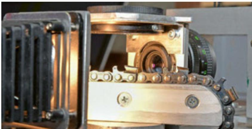
Instrument zur optischen Kontrolle von Brust-, Schneid- und Dachwinkel | Stephan Isler
