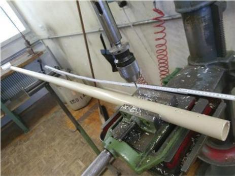
Abbildung 16: Perforieren der PVC-Vollrohre
