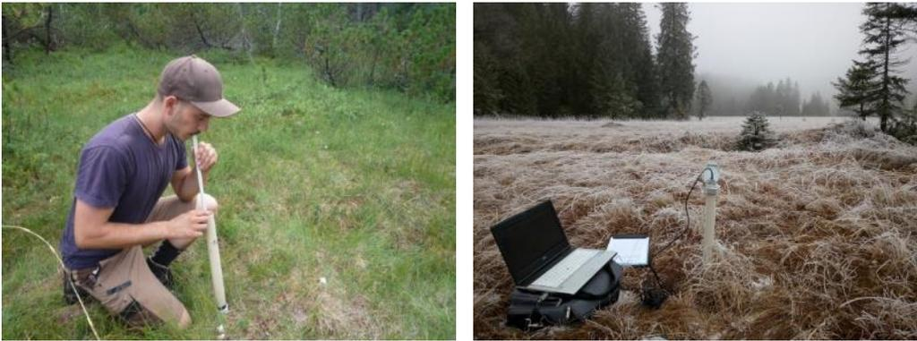
**Abbildung 21: Manuelles Ablesen des Wasserstandes und Datentransfer**
