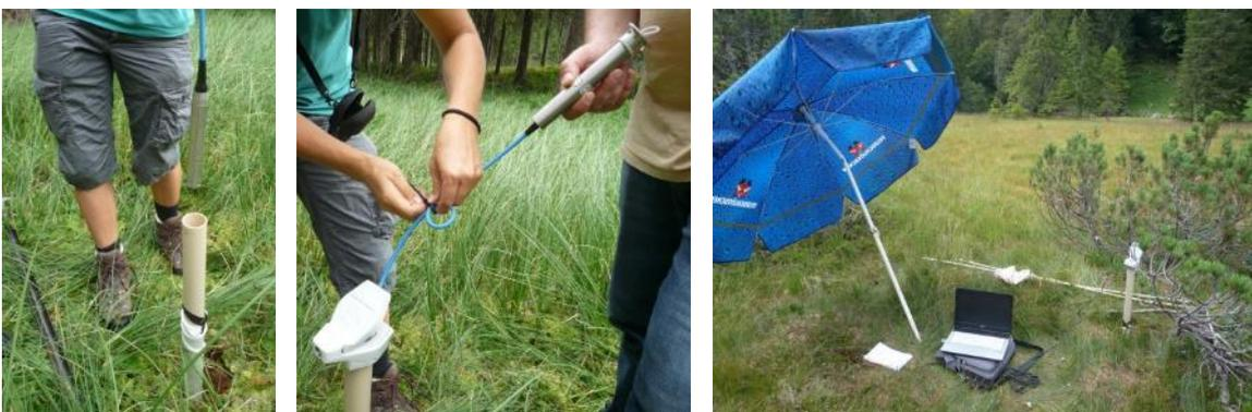
**Abbildung 20: Einlassen der Sonde und deren Kalibrierung**
