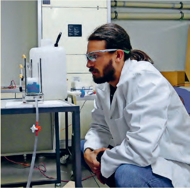
Ce dispositif du laboratoire permet à Michael Lombardo, doctorant, d'étudier quand l'eau s'accumule au niveau de l'interface entre la neige et le sol. La neige se situe au-dessus d'une couche de sable qui simule le sol.
